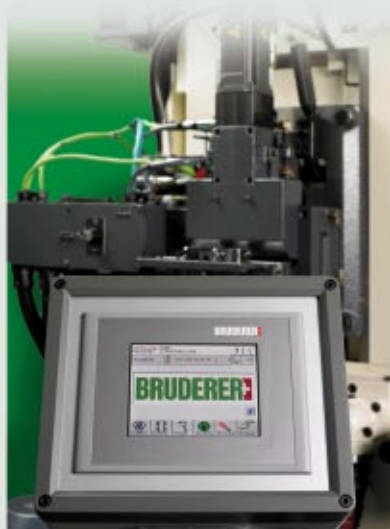
スタンドアロン型送り装置の タッチパネル操作盤
