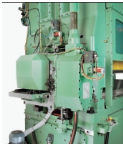
▲ Le nouvel aménagement BBV 450 a été spécialement étudié par Bruderer pour répondre aux exigences induites par la presse rapide BSTA 2500-250 BF.
