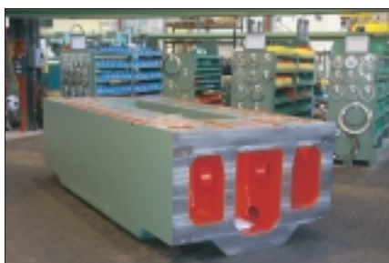
▲ La table de la BSTA 2500-250BF. Organe important pour la rigidité de l'ensemble, il a été conçu pour absorber efficacement les chocs engendrés par la découpe.
