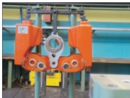
▲ Mécanisme d'une presse Bruderer : sa conception permet de minimiser les efforts subis par les intermédiaires et d'appliquer l'effort utile de travail dans l'axe des colonnes de poussée.
