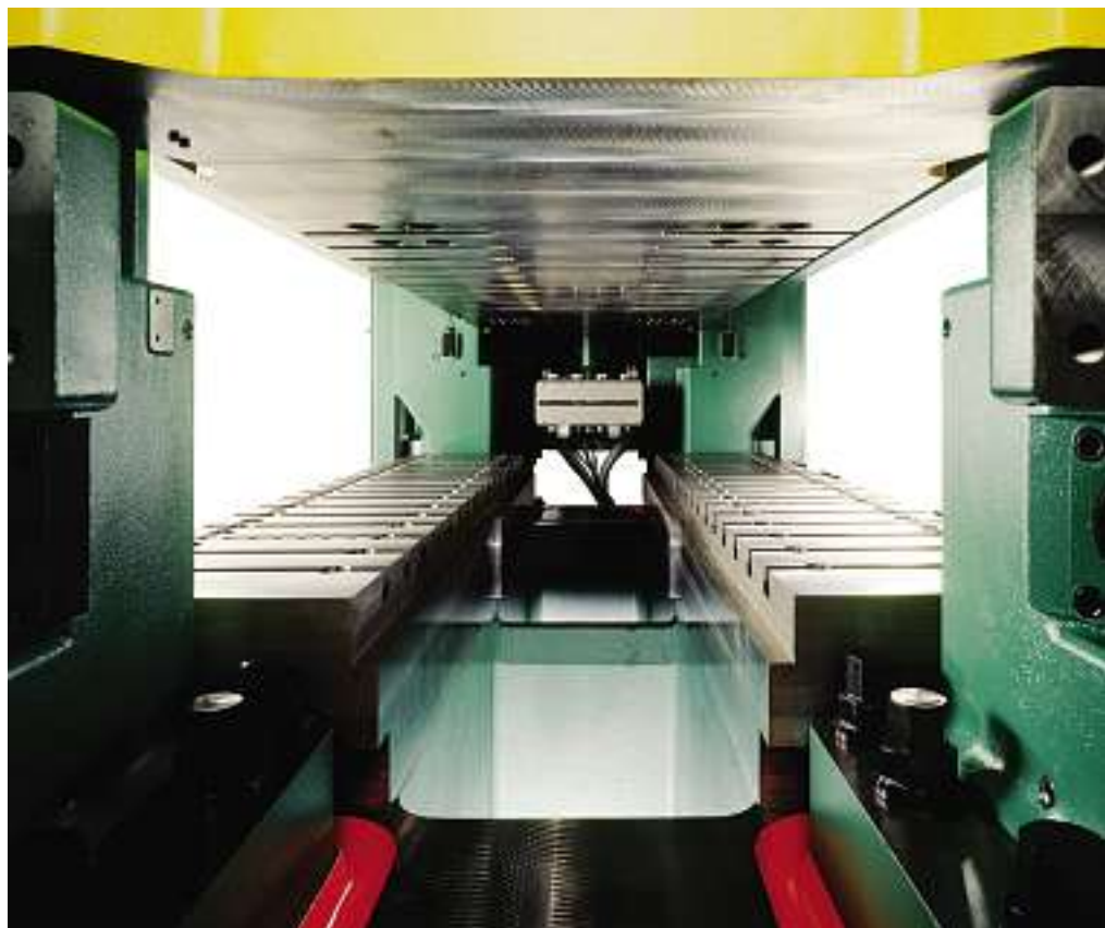
So groß war der Werkzeugraum noch bei keinem Bruderer-Stanzautomaten: Für Bänder bis 500 mm Breite stehen 2.500 mm Werkzeugeinbauraum zur Verfügung.
