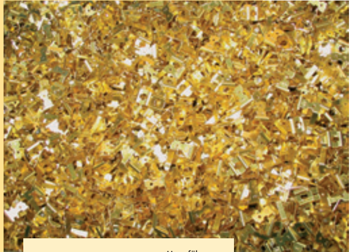
STANZEN, STANZEN, STANZEN: Ungefähr 17 Millionen dieser Schalterkontakte fertigt Jung jährlich in gleichbleibend hoher Qualität
