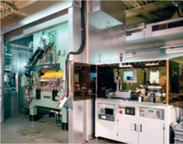
BILD 3. SCHNELL AMORTISIERT: Diese Anlage auf Basis eines Bruderer-Stanzautomaten produziert jährlich weit mehr als 20 Millionen Kontaktfederbaugruppen
