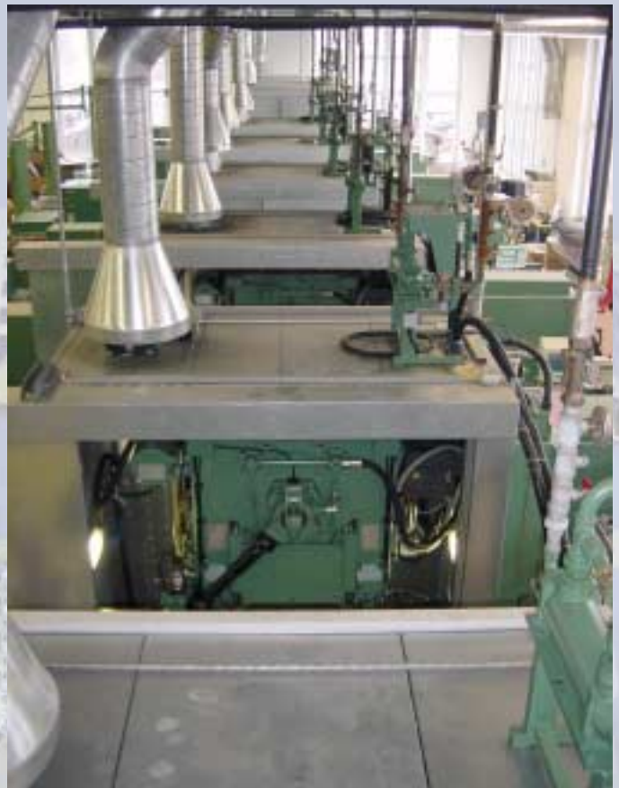
Durch Absaugen der Abwärme und Wärmetauscher auf den Pressen schwankt die Öltemperatur nur um maximal 8°C.
