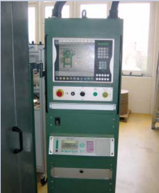
Da die Bediener zwischen zwei und vier Anlagen betreuen, legt Erni großen Wert auf einheitliche Bedienung an allen Pressen.
